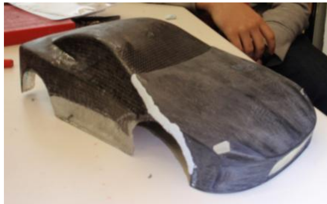
Figura 6. Acabado de la carrocería
