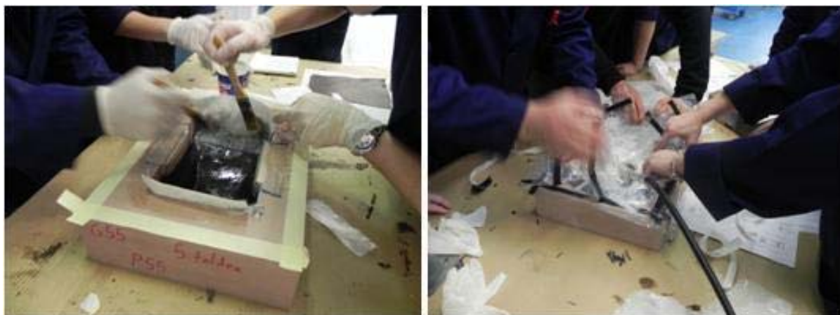
Figura 4. Fabricación del laminado por contacto a mano y bolsa de vacío
