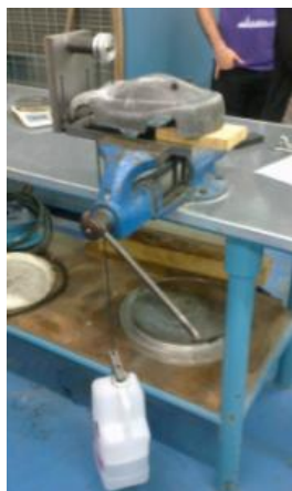
Figura 7. Dispositivo de medida de la rigidez a torsión
