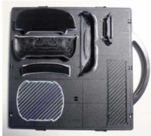
Figura 5. Fabricación de los elementos auxiliares mediante la impresora 3D
