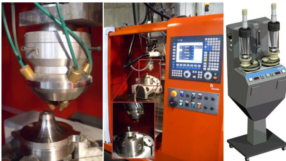
Figura 1. a) Boquilla coaxial discreta b) Aktinos-500+Mesa Tilting c) Alimentador SULZER Metco Twin10C
