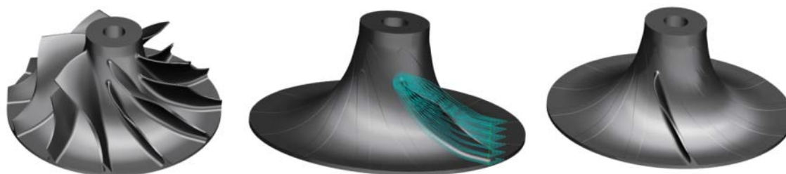
Figura 4. a) Croquis de la pieza a fabricar. b) Trayectorias de aporte c) Acabado del álabe.
