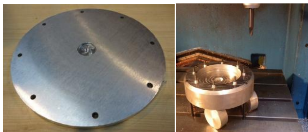
Figura 1. Izq.) Probeta lista para ser colocada en el dispositivo de sujeción. Dcha.) Montaje de dispositivo y probeta en el centro de mecanizado
