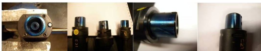
Figura 3. Imágenes de las zonas de contacto (Sandvik®).
