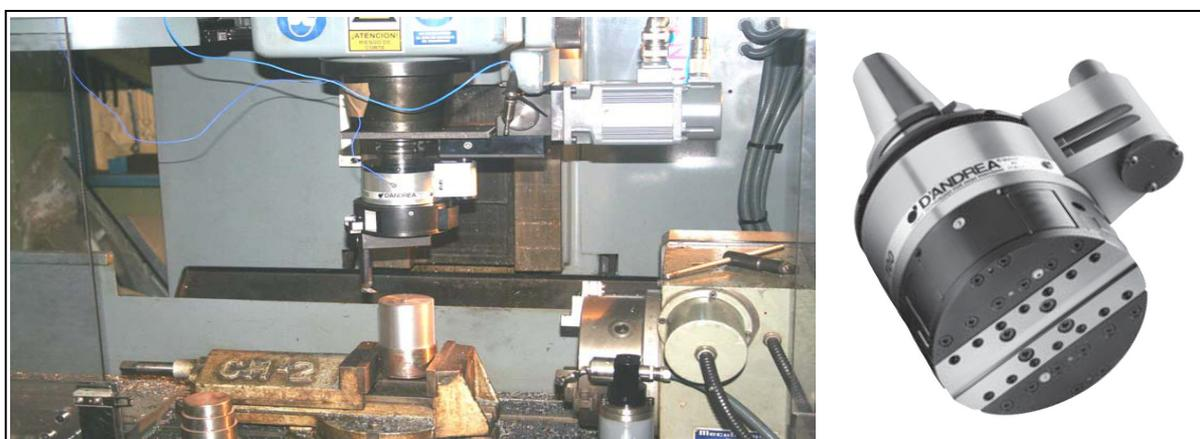
Figura 2. Detalle del cabezal D'Andrea montado en el centro de mecanizado de la EUITI de Bilbao.
