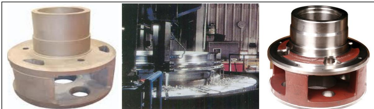
Figura 1. Planetarios para reductoras de molinos de viento.
