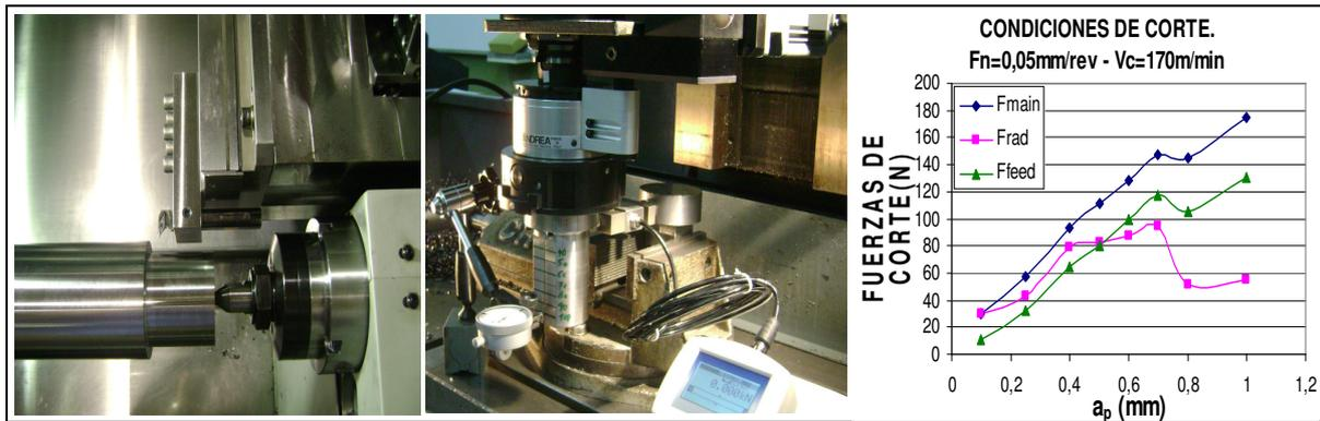
Figura 6. Caracterización de las fuerzas de corte para el binomio material-herramienta.
