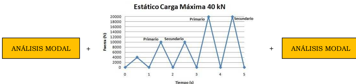
Figura 7. Esquema del procedimiento de análisis definido en el modelo MEF
