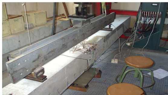
Figura 2. Viga ensayada en el Laboratorio de Estructuras de la E.T.S.I.I.M
