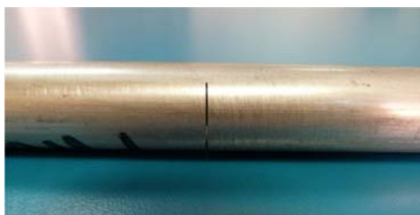
Figura 4. Entalla previa realizada a los ejes
