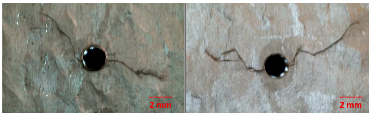
Figura 5. Grietas creciendo desde una entalla circular de 2 mm. de diámetro. Se observan los cambios de dirección del plano de la grieta y ramificaciones
