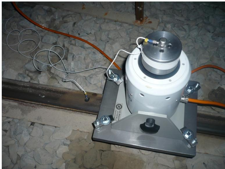
Figura 5. Disposición del actuador electrodinámico fijado a la cabeza del carril encima de una traviesa
