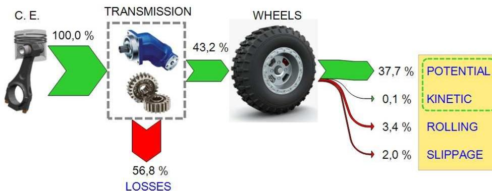
Figura 5. Diagrama de Sankey de la transmisión
