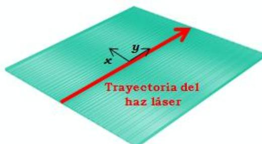
Figura 2. Mecanismo TGM de conformado directo por láser (DLF).
