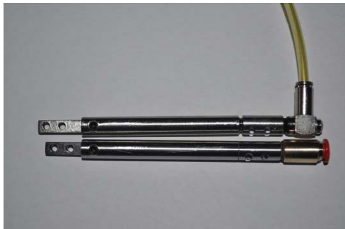
Figura 2. Detalle del adaptador para dos tipos de conectores. Arriba conector a 90°, abajo conector recto
