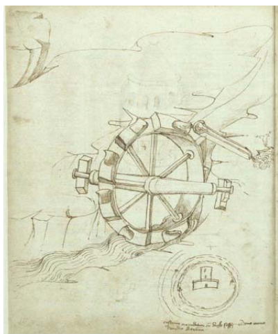
Figura 1a. Mejora de rueda hidráulica gravitatoria [3]. Figura 1b. Rueda hidráulica gravitatoria [4]
