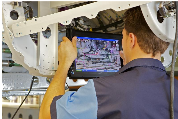
Figura 6. Sistema MOON de ayuda al montaje de instalaciones mediante realidad aumentada
