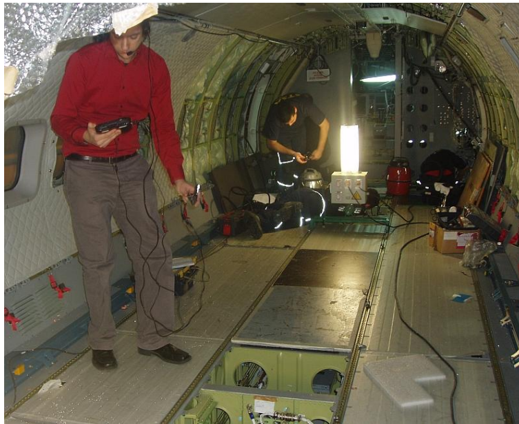
Figura 4 Sistema SUN de ayuda al operario en zonas de difícil acceso
