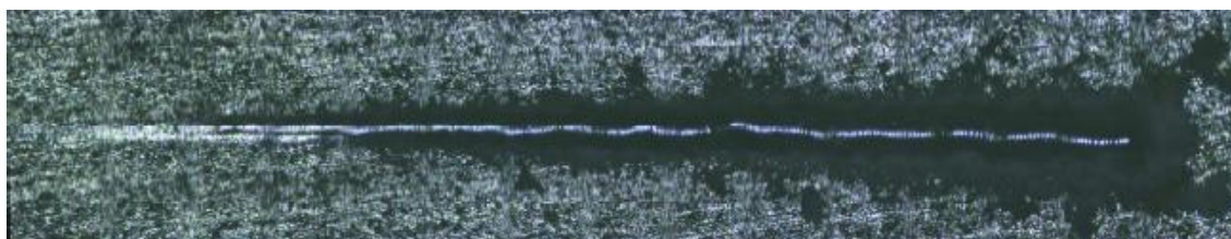
Figura 6. Micrografía panorámica del recubrimiento ( 60\%\text{Al}_2\text{O}_3+40\%\text{TiO}_2 )
