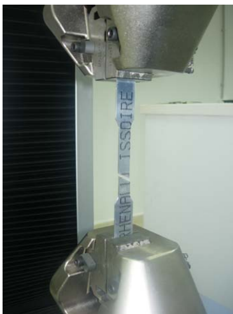
Figura 4. Muestra de ensayo fracturada en dos partes claramente desiguales
